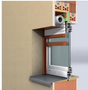
Geschlossener Kasten, Oberfläche einbrennlackiert, mit Druckgussblendenkappen, Einlaufrichter aus Kunststoff, Gurtscheiben mit Kugellager, Stahl-8-Kantwelle und beschichteten Stahlbandaufhängern, Kastengröße wie erforderlich. Kastengrößen und Kastenfarben entsprechend unserer Ausstattungsübersicht auf den folgenden Seiten.
